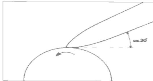
Die Werkzeugschneide immer in Drehrichtung der Scheibe halten.
